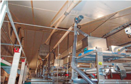
Imagen 3. Ejemplo de sistema de reparto de alimento bien dimensionado
